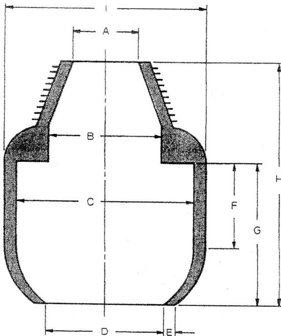
耐圧 30kv 試験済み
